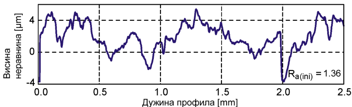
Слика 6.1.2: Профил храпавости поља са иницијалном храпавошћу R_{a(ini)}=1.39 \mu\text{m}
