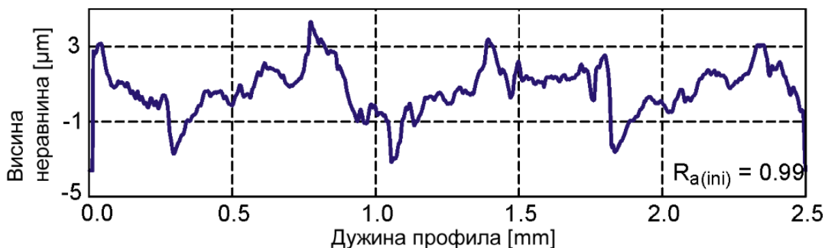
Слика 6.1.1: Профил храпавости поља са иницијалном храпавошћу R_{a(ini)}=0.99 \mu\text{m}
