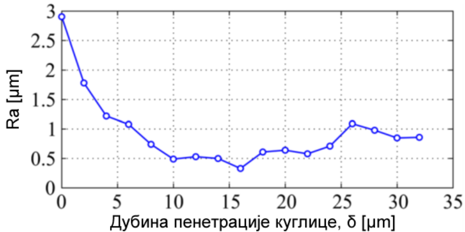
Слика 7.6.3: Зависност између површинске храпавости R_a и дубине пенетрације куглице у материјал предмета обраде \delta добијена експерименталним путем
