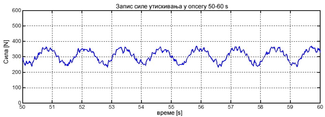
Слика 6.2.11: Запис силе за пето поље са финим претходном обрадом
