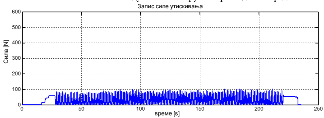
Слика 6.2.2: Запис силе за дуго поље са грубом претходном обрадом
