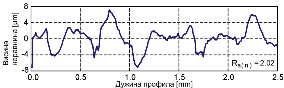
Слика 6.1.3: Профил хрпавости поља са иницијалном хрпавошћу R_{a(ini)}=2.02 \mu m
