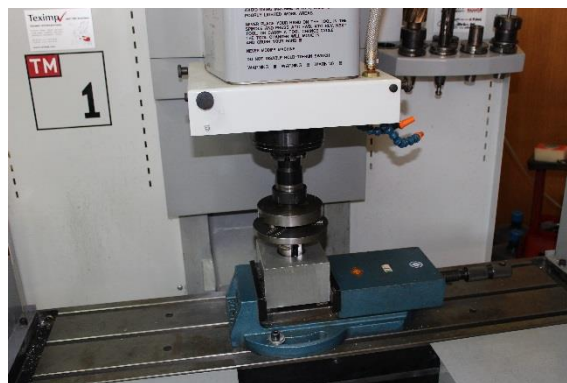
Слика 4.2.3: Приказ алата намењеног за завршну обраду отвора
