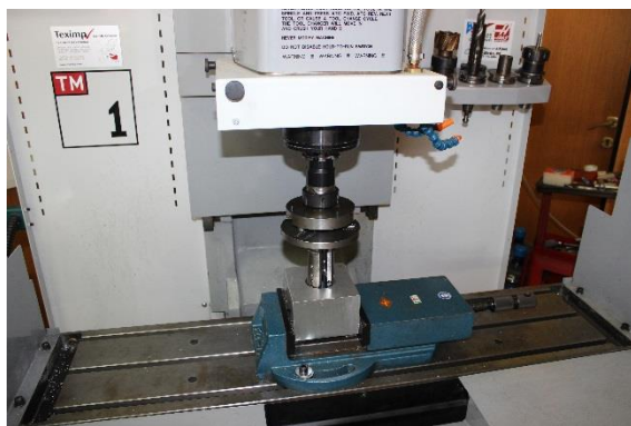
Слика 4.2.3: Приказ алата намењеног за завршну обраду отвора
