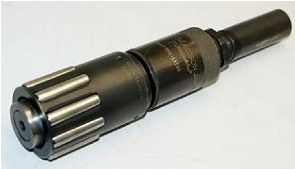
Слика 2.2.2: Алат за обраду котрљањем по површини предмета обраде
