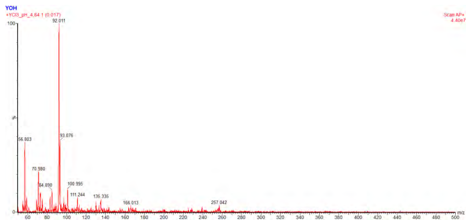
Слика 23. ESI MS спектар хидролизе Y(III)-јона концентрације 0,05 \text{ mmol dm}^{-3} на pH 4,84 снимљен у позитивном моду
