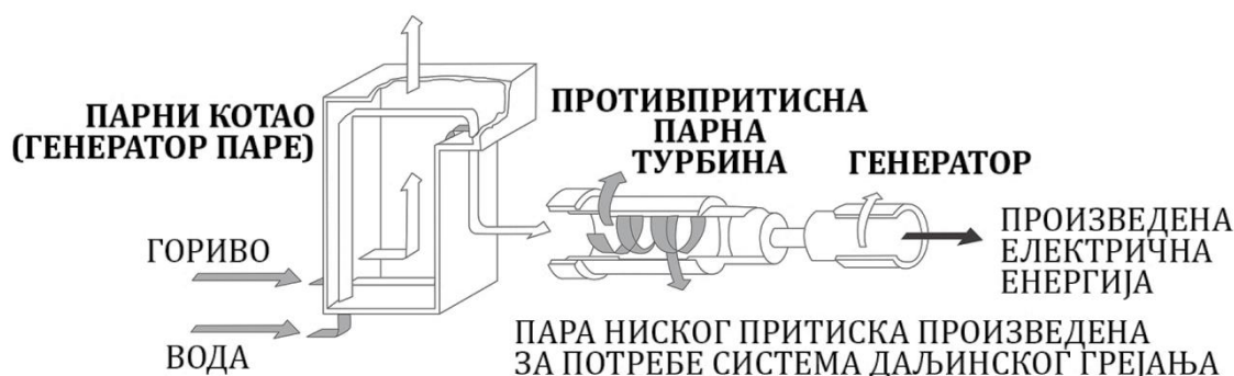
Слика 2.9. Противпритисна парна турбина у систему даљинског грејања
