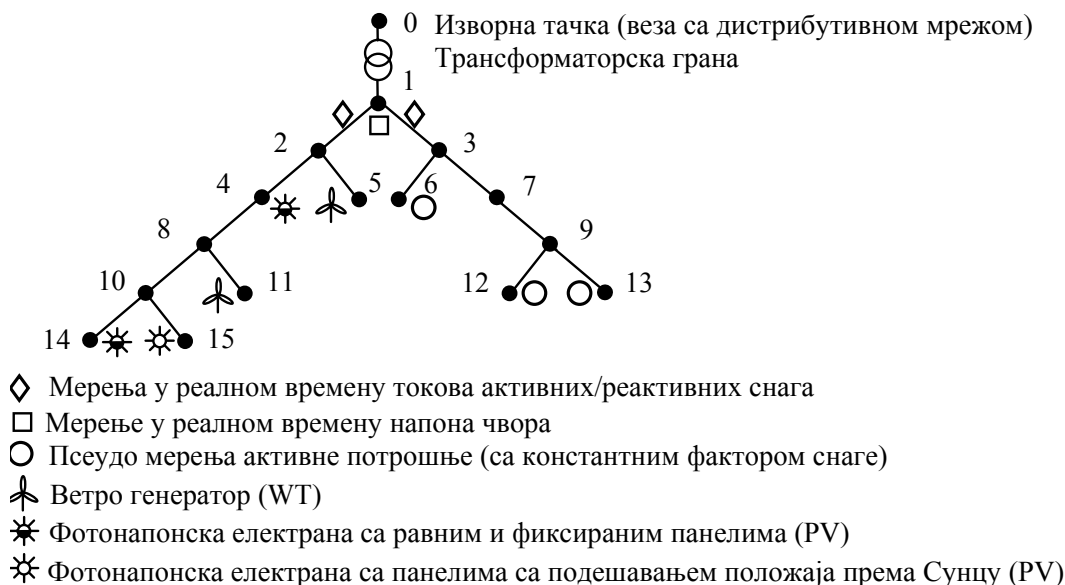
Слика 7.4: Топологија и распреди дистрибуираних генератора и мерења у анализираној микро мрежи.
