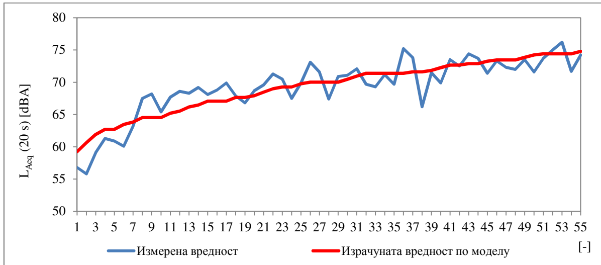
Слика 8.3. Упоредна анализа експерименталних вредности измерене буке L_{\text{Aeq}}(20\text{ s}) и резултата предложеног модела за СТВ у зависности од брзине кретања V
