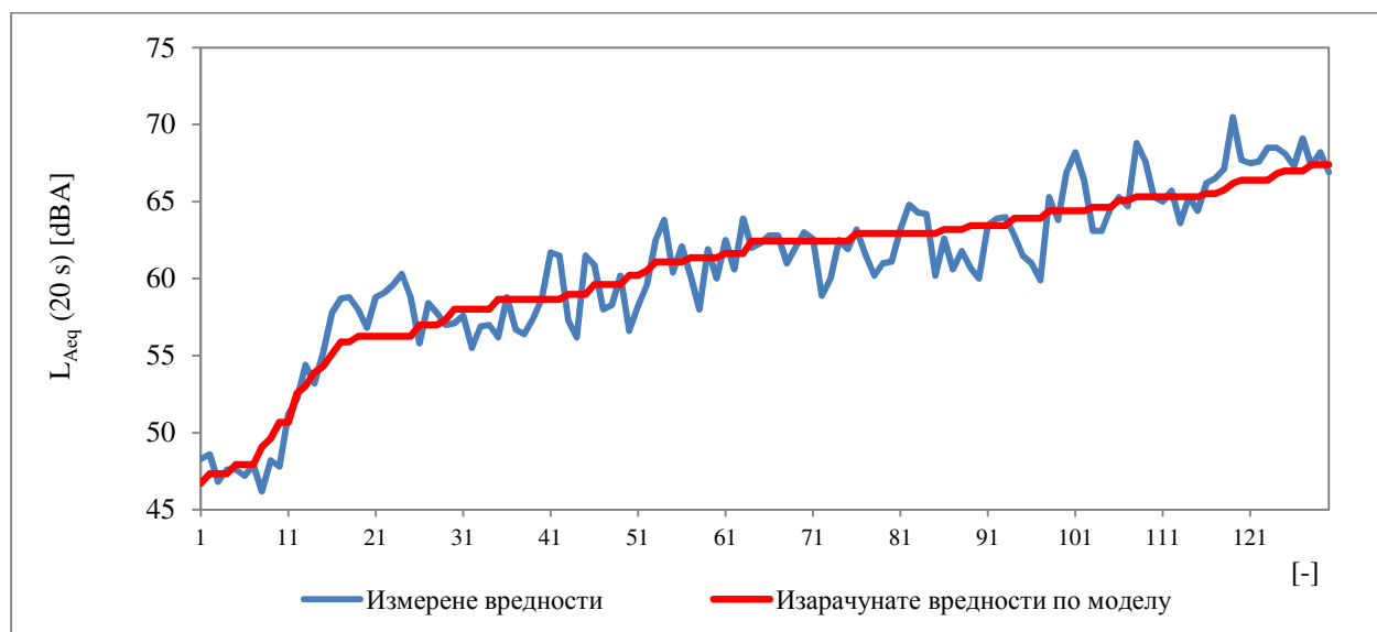
Слика 8.1. Упоредна анализа експерименталних вредности измерене буке L_{Aeq}(20\text{ s}) и резултата предложеног модела за ЛМВ у зависности од брзине кретања V
