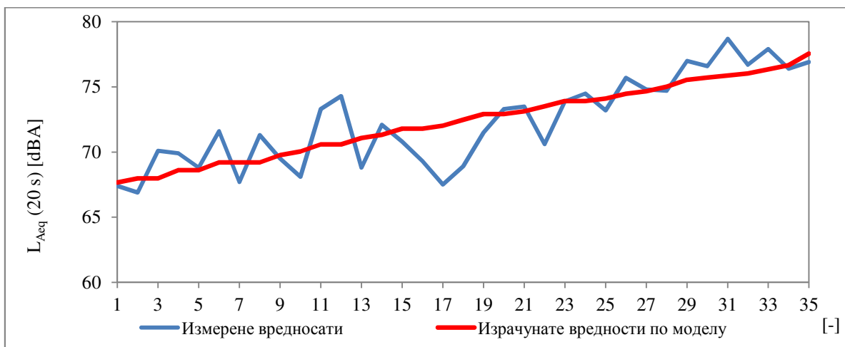
Слика 8.7. Упоредна анализа експерименталних вредности измерене буке L_{Aeq}(20s) и резултата предложеног модела за БУС у зависности од брзине кретања V
