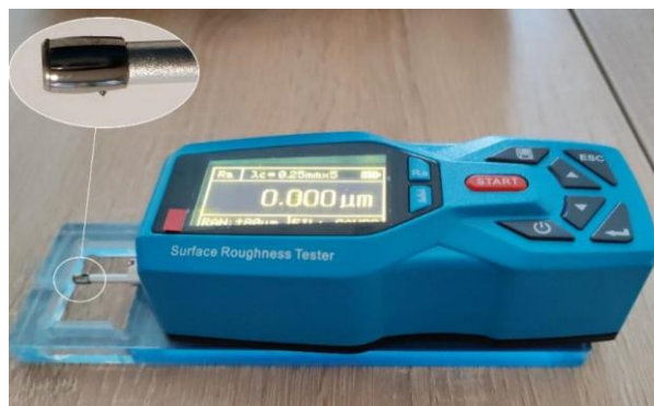
Слика 4.31. Уређај ART300 Surface Roughness Gauge за мерење храпавости
