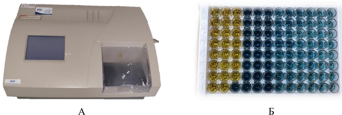
Слика 5: ELISA читач ( Auto Microplate reader (MRC VT 2100C, Holon, Israel) ) (A); Изглед микротитар плоче по додавању раствора за заустављање реакције и промени боје из плаве у жути (Б)
