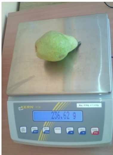
Сл. 5. Одређивање масе плода Вилијамовке на техничкој ваги KERN FCB (Kern & Sohn GmbH, Belling, Germany) (Р. Илић, ориг.)
