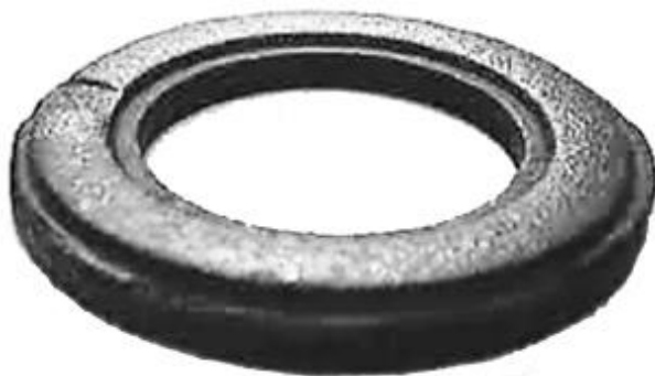
Сл. 2.11 Губитак аеро-динамичности запивног прстена вентила због појаве коксовања
