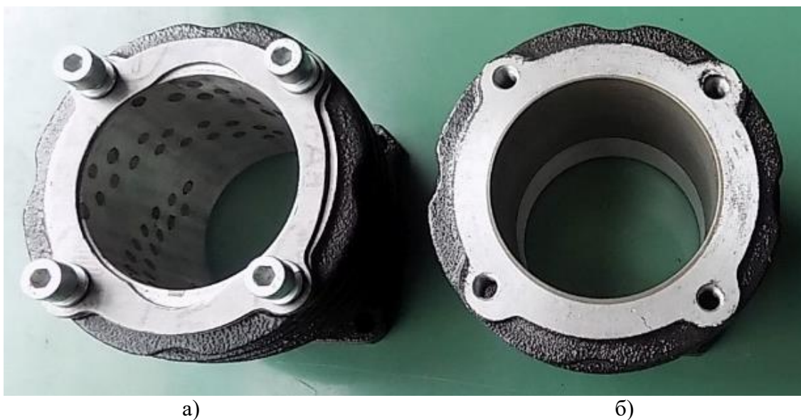
Сл. 4.20 Фотографије цилиндара клипног компресора: а) са дискретним чеповима сферног облика (нодула) и б) са формираном превлаком спреј поступком
