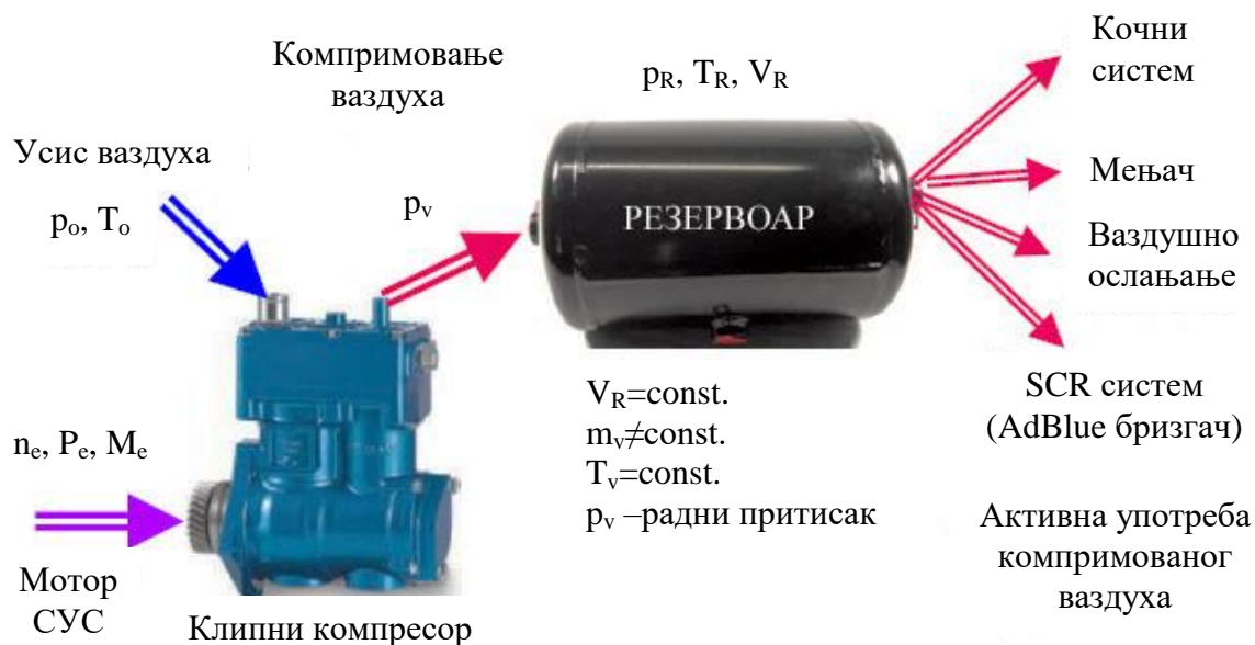
Сл. 4.9 Модел инсталације за симулацију промене притиска компримованог ваздуха на теретним моторним возилима и аутобусима
