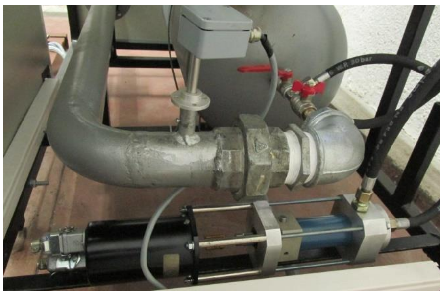
Сл. 4.13 Фотографија уграђеног аутоматског серво-вентила са погонским серво-мотором на излазном воду из резервоара са компримованим ваздухом
