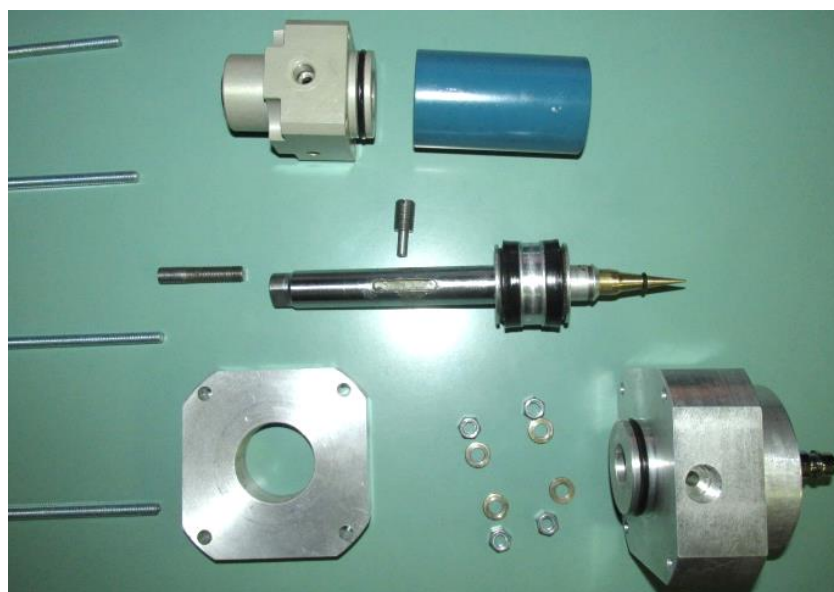
Сл. 4.15 Делови цилиндра ППТ - Петолетка после реконструкције у конусни серво-вентил за потребе аутоматизације поступка испитивања клипних компресора
