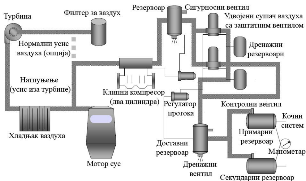
Сл. 2.6 Инсталација за компримовани ваздух са двоцилиндричним клипним компресором са циклусима оптерећења преко 25% [13]
