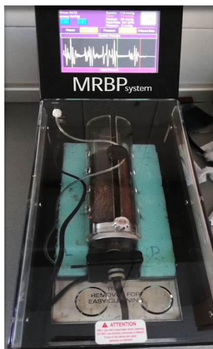
Слика 4. Мерење крвног притиска и срчане фреквенце код пацова, употребом апарата Rat Tail Cuff Method Blood Pressure Systems (MRBP-R) , IITC Life Science Inc., Los Angeles, CA, USA
