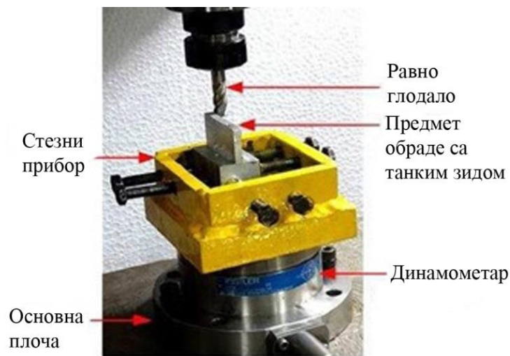
Слика 2.3 – Експериментална поставка за машинску обраду танких зидова.
