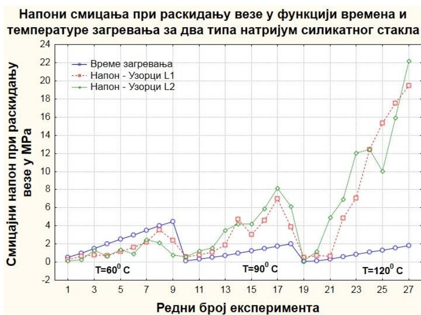
Слика 5.4 – Носивост споја са аспекта напона смицања [1].
