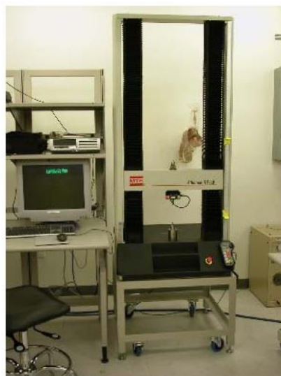
Слика 2.1.15 – Универзална машина за испитивање са ћелијом за притисак монтираном на попречну главу.
