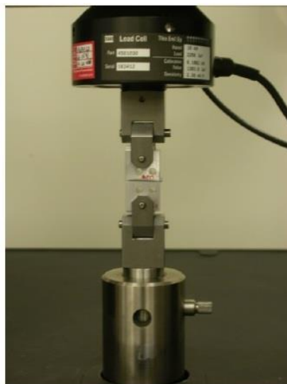
Слика 2.1.14 – Уређај за оптерећење са тест блоковима монтираним за квадратну испитну површину од 25 mm која се оптерећује затезањем. Обратите пажњу на два монтажна пина у центру тестне површине.
