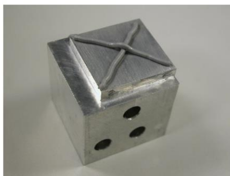
Слика 2.1.12 – Блок за испитивање затезањем спреман за монтажу са машћу TIM нанесеном на површину од 20 mm.
