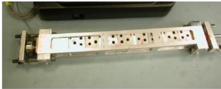
Слика 2.1.13 – Апаратура за тестирање која се користи за тестирање више испитних спојева.
