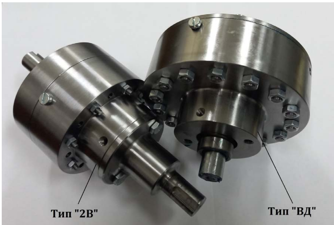
Слика 9.1. Прости циклопреносници коришћени у експерименту
