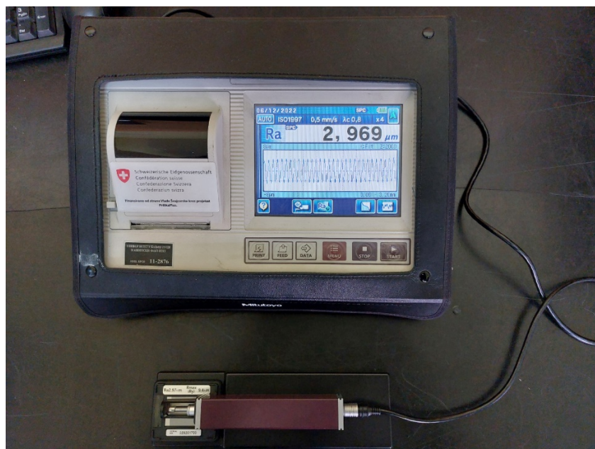
Слика 9.5. Мерач храпавости Mitutoyo surfptest SJ-310
