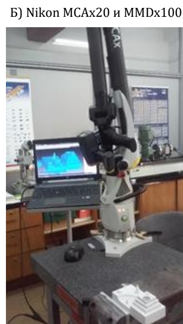
Слика 9.3. Израда и контрола облика циклозупчаника
