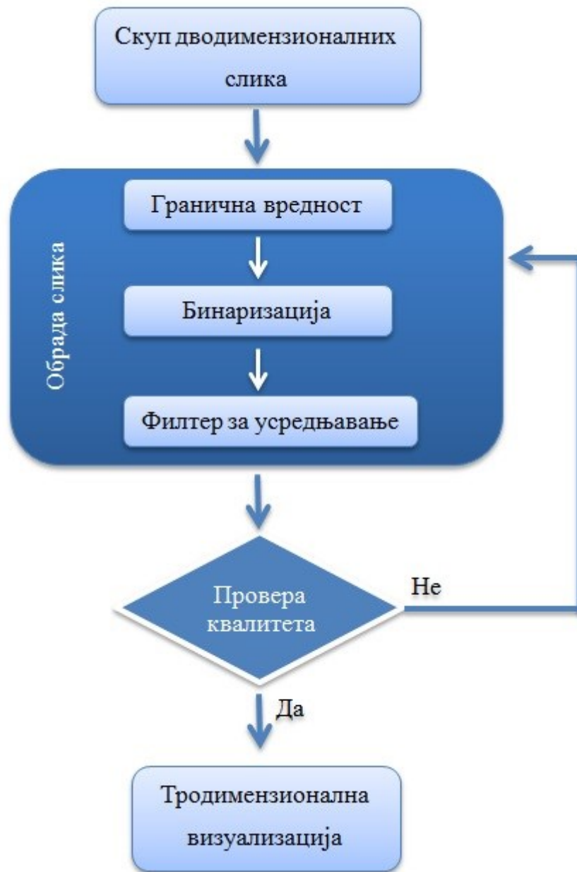
Слика 7.3 – Блок дијаграм алгоритма за тродимензионалну визуализацију мишјих плућа
