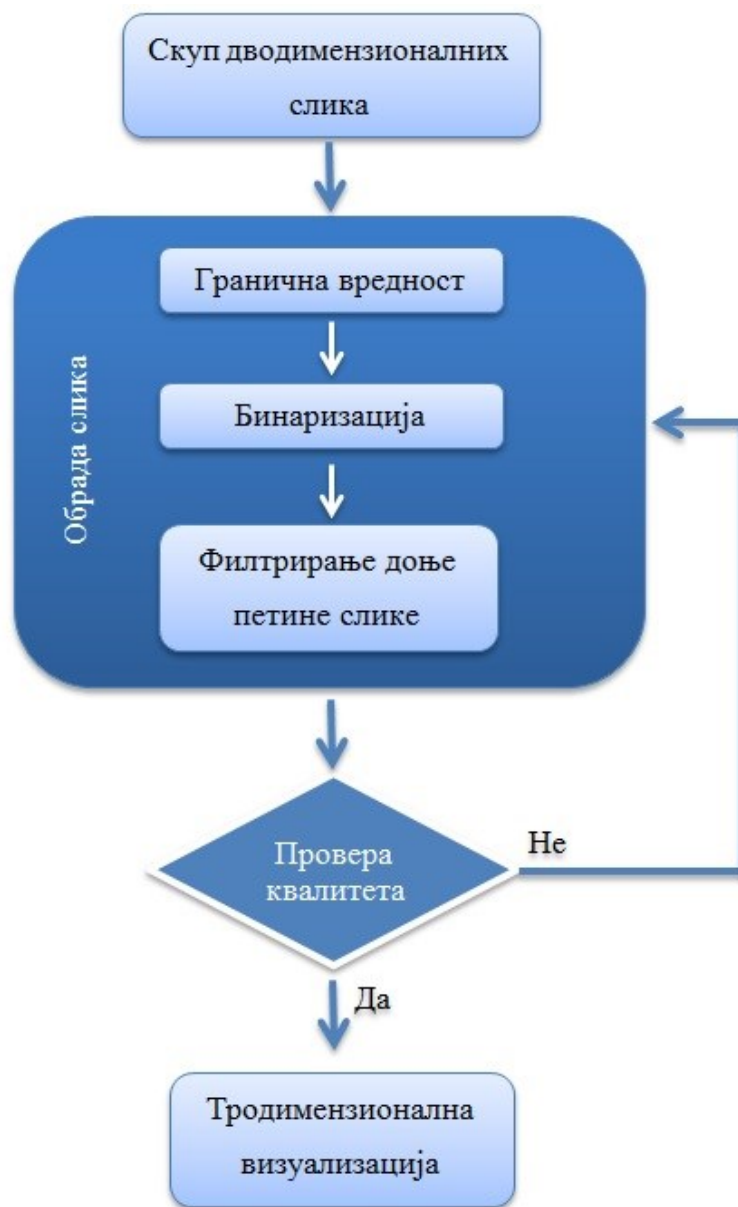
Слика 8.3 – Блок дијаграм алгоритма за тродимензионалну визуализацију колена
