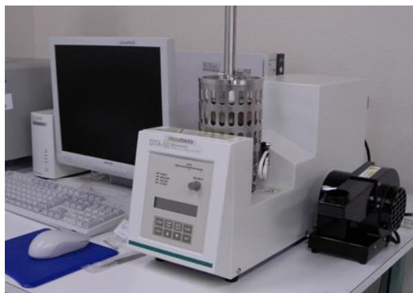
Слика 33. Уређај SHIMATZU DTA -50
