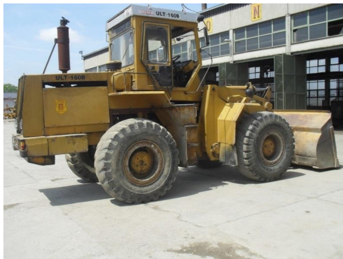
Слика 9.6.1 Изглед грађевинске машине-утоваривача ULT-160 В
