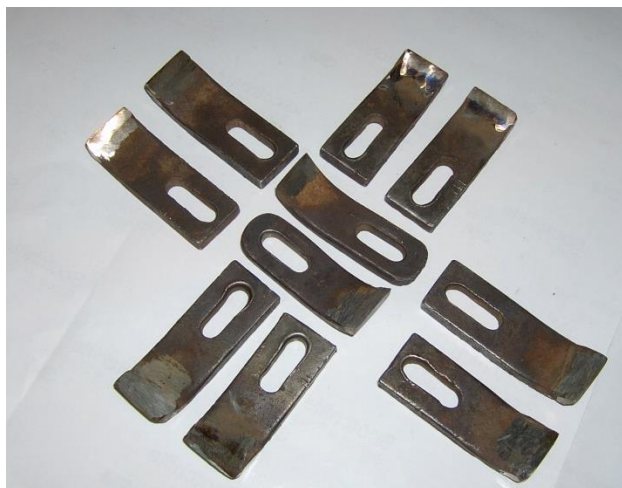
Слика 9.6.32 Изглед наварених и наоштрених ножева уређаја за чишћење растиња
