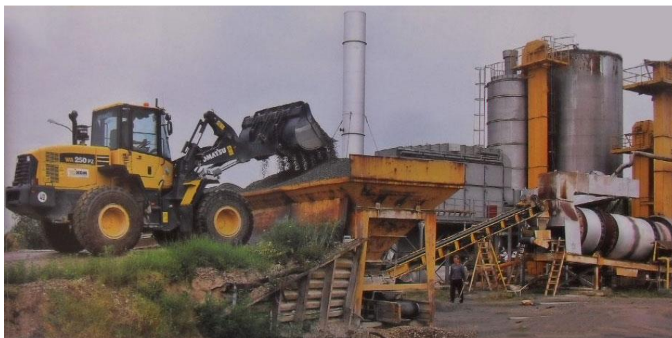
Слика 9.6.12 Изглед асфалтне базе капацитета 120 t/h
