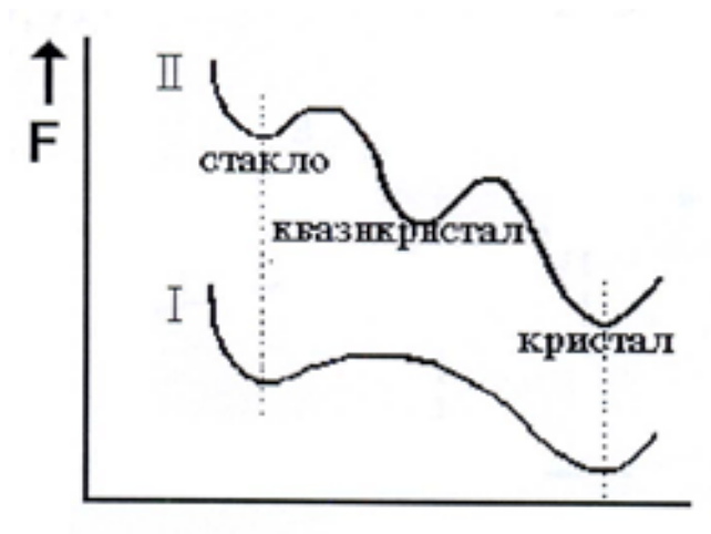
Сл. 2.12. Промена слободне енергије F за две класе аморфних материјала: ( I ) директна трансформација аморфног стања у уређеније кристално стање, ( II ) трансформација стакла у квазикристално стање, а затим у кристално стање [80].
