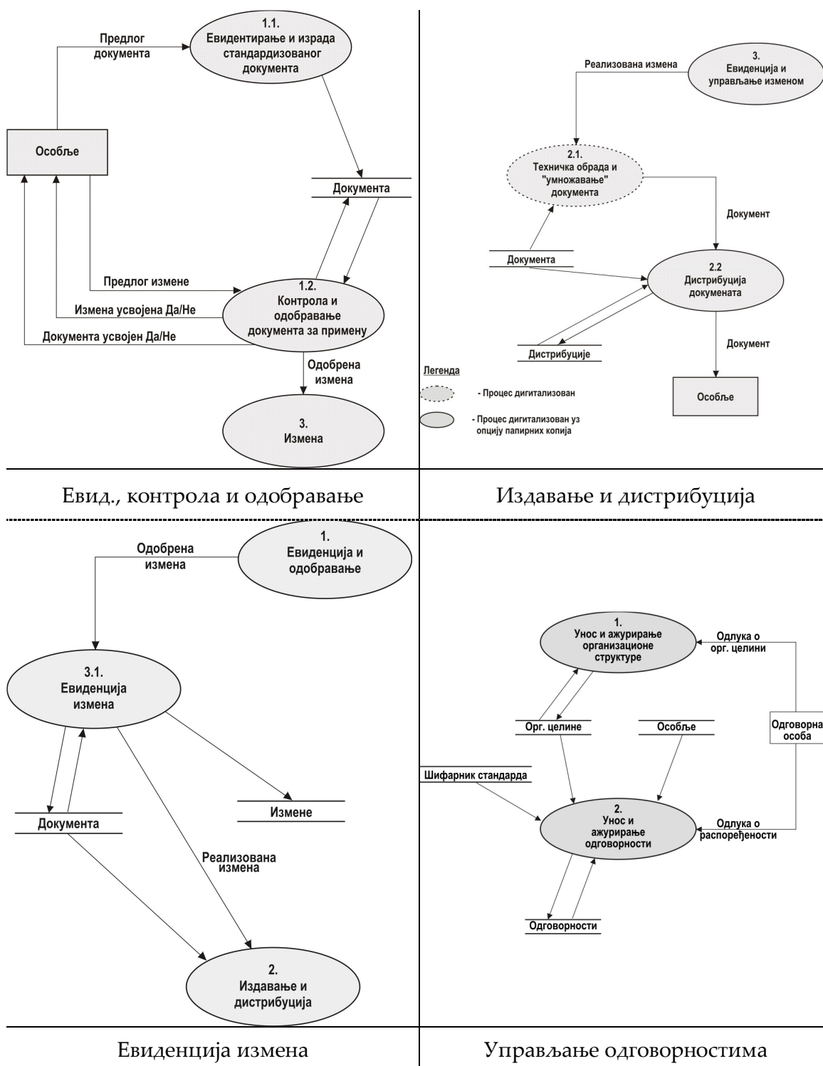
Слика 57 Информациони подсистем за управљање документацијом (основни процеси на другом нивоу декомпозиције)
