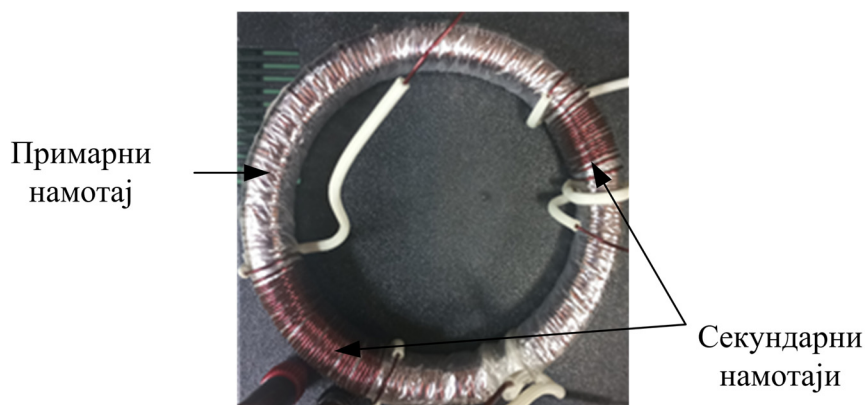
Слика 9.2 – Изглед намотаног торусног језгра.
