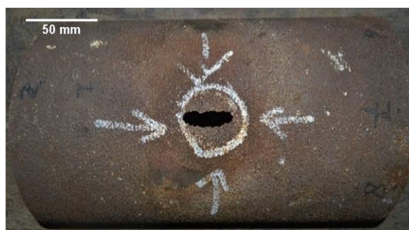
Слика 2.6. Цурење на спољној површини ASTM A351 HK40 цеви [76]
