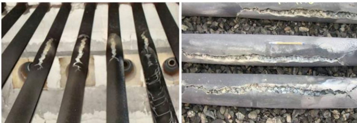
Слика 2.4. Узорци цеви након 70 000 сати рада код којих је дошло до појаве уздужних пукотина [62]
