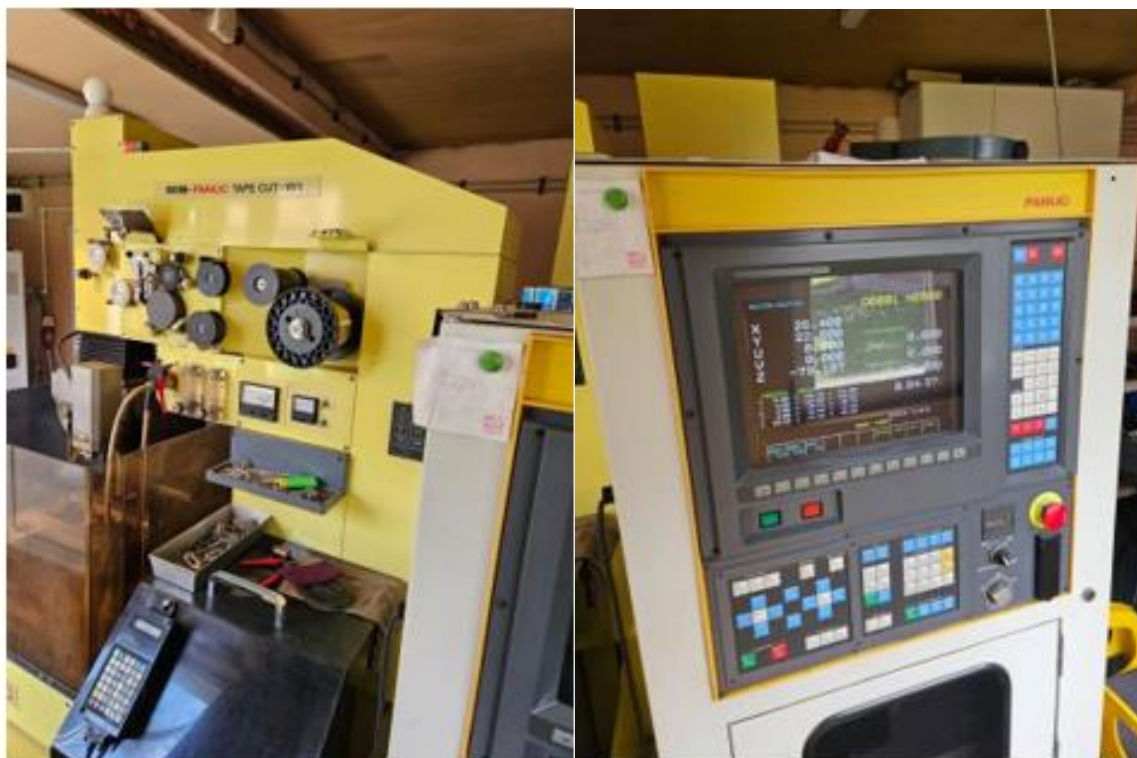
Слика 3.4. Ерозимат машина на којој су исечени узорци за металографска испитивања
