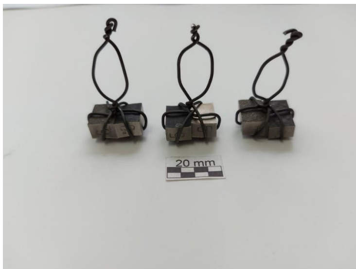
Слика 3.7. Исечени и обележени узорци за металографска испитивања спремна за прегревање
