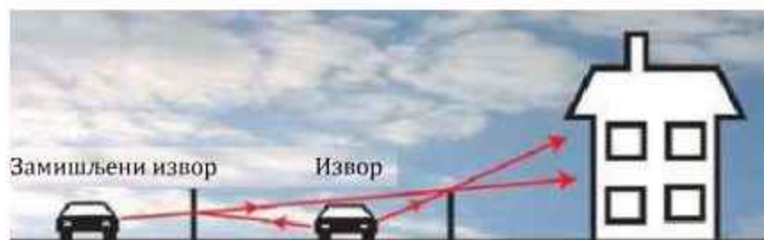
Слика 2.13. Пример деловања дифрактованих зрака од замишљеног извора [24]
