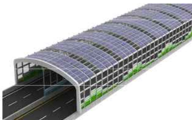
Слика 3.30. Тунелска баријера комбинована са соларним панелима [50]
