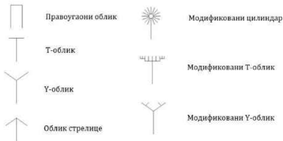
Слика 3.52 Различити облици дифракционих капа (Прилагођено из [60])
