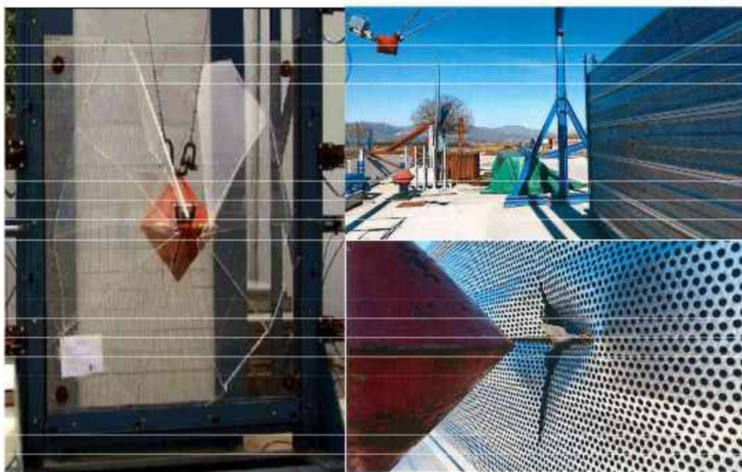
Слика 5.37. Испитивања секундарне сигурности СЗБ [114]
