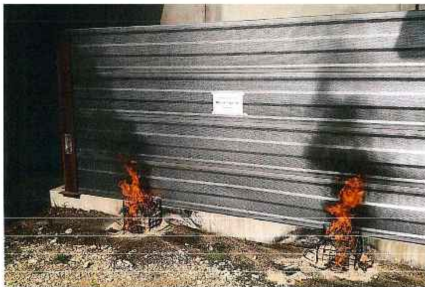
Слика 5.36. Испитивања панела СЗВ на отпорност на ватру шибља
