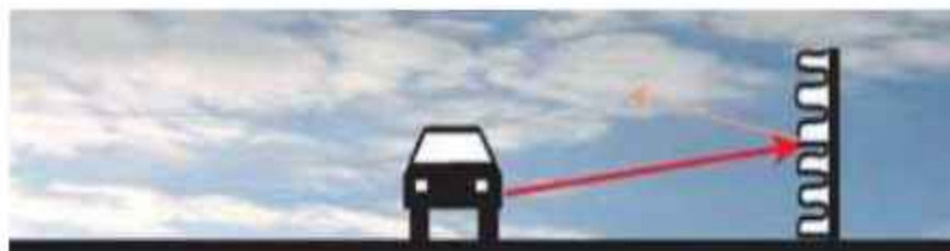
Слика 2.15. Пример баријере са звучно апсорбујућим површинама [24]
