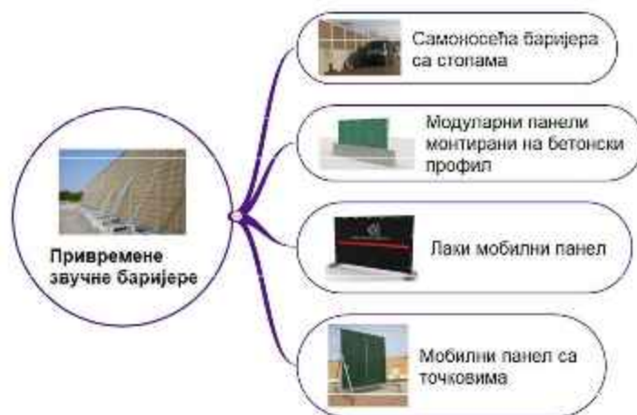
Слика 3.41. Класификација привремених звучних баријера
