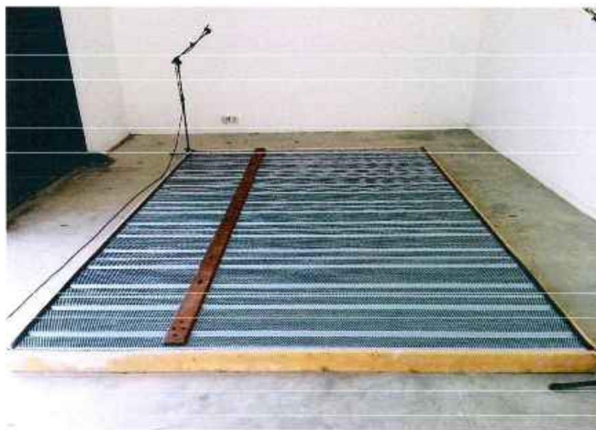
Слика 5.25. Испитивање узорка СЗБ у реверберационој комори
