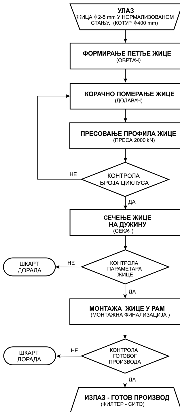
Слика 1.13: Алгоритам технолошког процеса израде пукотинастог сита
