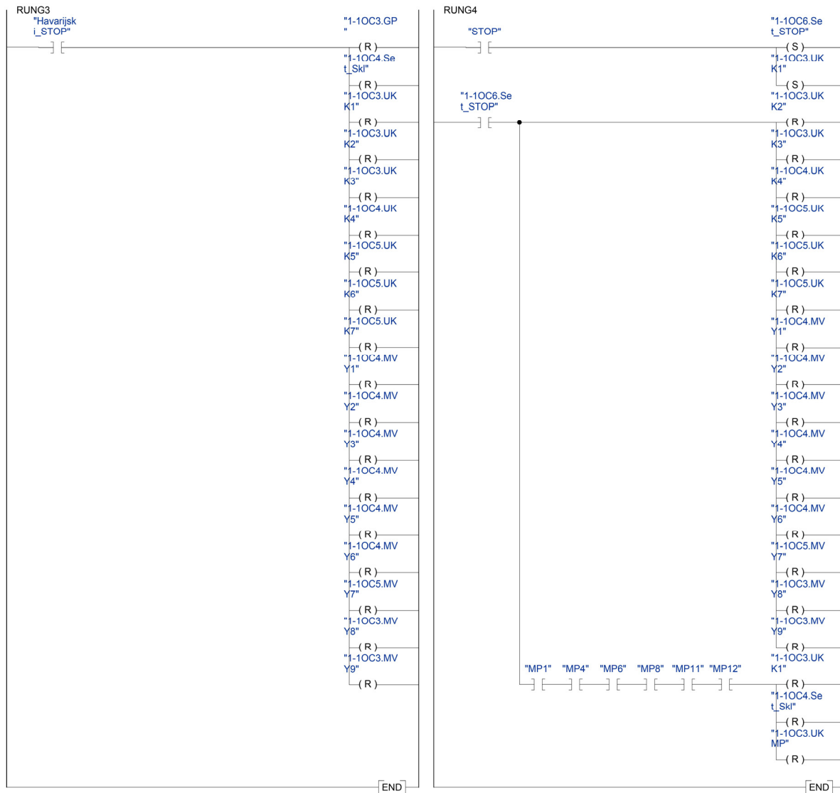
Слика 5.9в: Извршни програм PLC контролера – део 3 и 4
