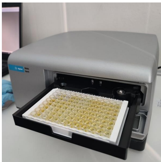
Слика 22. ELISA читач коришћен за мерење апсорбанце испитиваних маркера у овом истраживању
