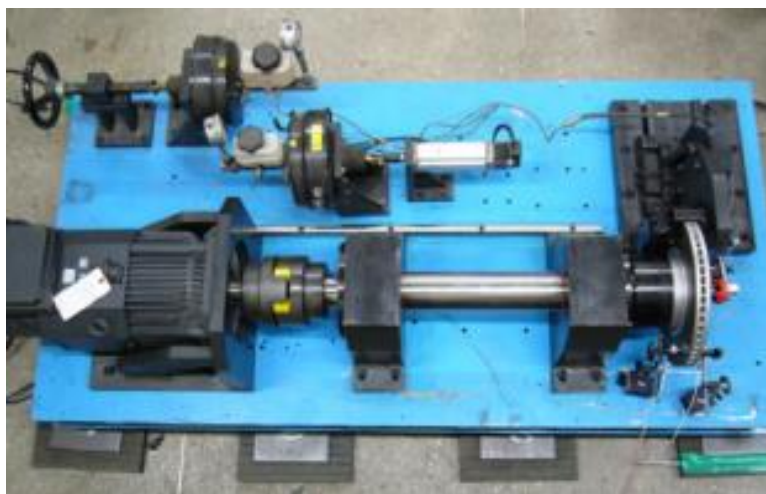
Слика 2.9 Пробни сто – динамометарска шасија [59]
