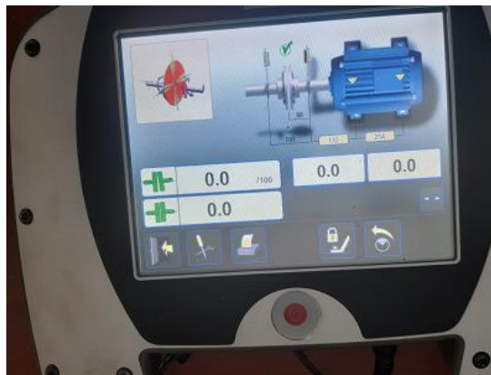
Слика 3.24 Приказ извршеног центрирања мотора
