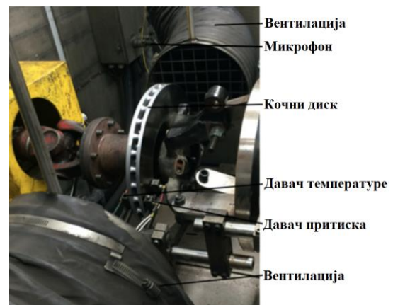
Слика 2.17 Пробни сто за праћење појаве буке диск кочнице [67]
