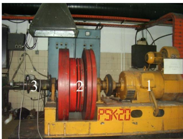
Слика 2.7 Пробни сто за испитивање кочница аутомобила и лаких комерцијалних возила: 1-мотор, 2-замајне масе, 3-прирубница за везу обртног дела кочнице [58]
