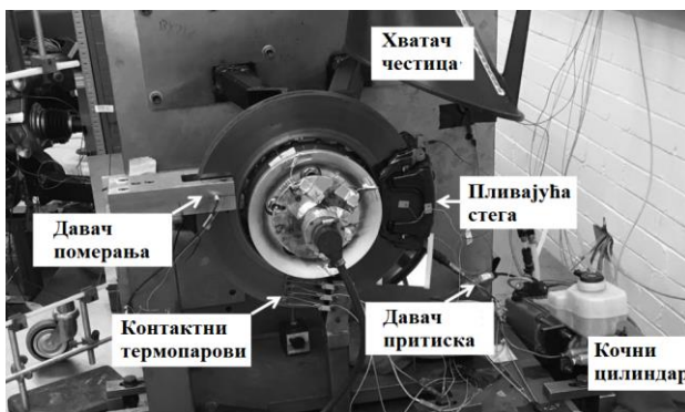
Слика 2.16 Изглед пробног стола са примењеним давачима [66]
