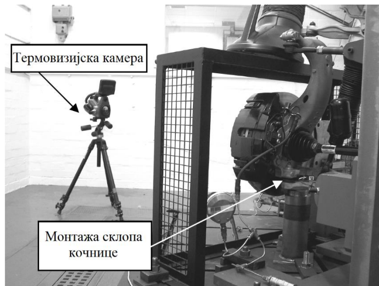
Слика 2.18 Позиција термовизијске камере у односу на пробни сто [64]
