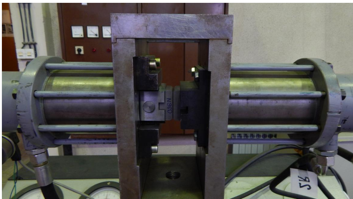
Слика 6.8 Изглед механичког дела уређаја за провлачење траке лима између равних контактних површина
