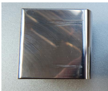
Слика 7.15 Трагови налепнина трака лима на контактном елементу са: а) полираном површином, б) превлаком од титан-нитрида
