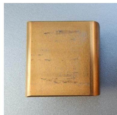
Слика 7.15 Трагови налепнина трака лима на контактном елементу са: а) полираном површином, б) превлаком од титан-нитрида
