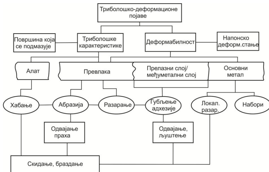
Слика 3.17 Триболошки и други фактори који утичу на стабилност и вид разарања превлаке [13]
