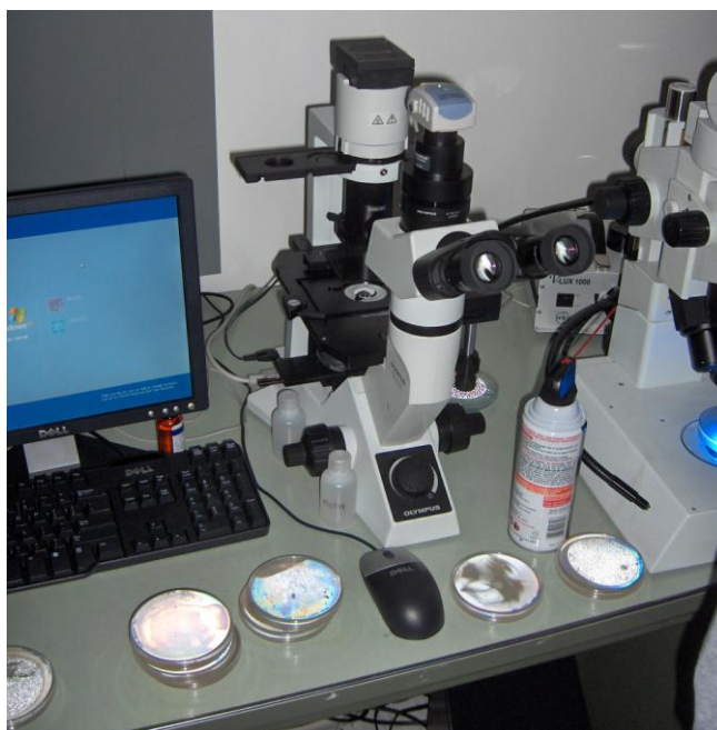
Слика 7.118 Изглед оптичког микроскопа „OLYMPUS GX41“ са максималним увећањем до 1000×
