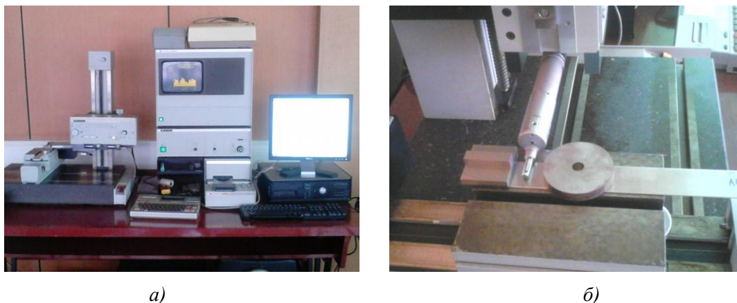
Слика 7.117 Изглед уређаја „Talysurf“ (а), мерење хрпавости на узорку лима (б)
